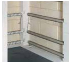
Свободное излучение тепла благодаря установке нагревательных элементов на керамических несущих трубах; оптимальное позиционирование обеспечивает достижение очень хорошей равномерности температуры.
