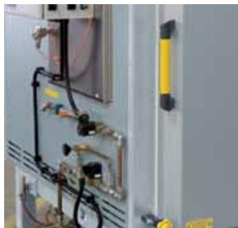
Газовое оборудование и термоэлемент в печи
