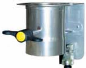
Если Ваша печь оснащена контроллером В 130 или другим контроллером, не имеющим специальной функции активации заслонки, то в качестве альтернативы Вы можете использовать полуавтоматическую заслонку приточного воздуха, которая управляется при помощи таймера. Заслонка закрывается при помощи электромагнита, после того, как истекает выбранное время. Возможна дополнительная установка такого полуавтоматического варианта.
